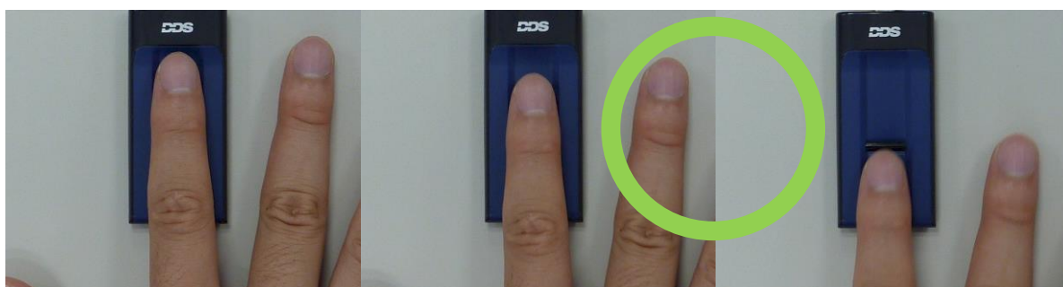
[写真 17] 指紋センサーの読み取り部に対して、直交する方向に、指を滑らせます。
