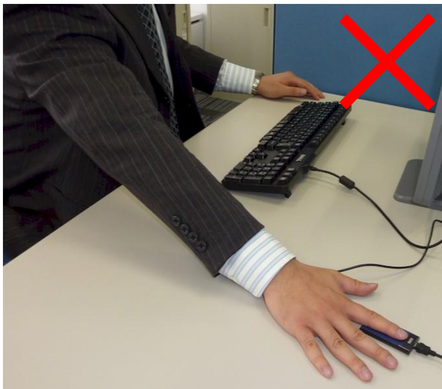
[写真 4] 指紋センサーを体から遠くに置くと、腕が伸びきってしまい、安定した入力できません。
